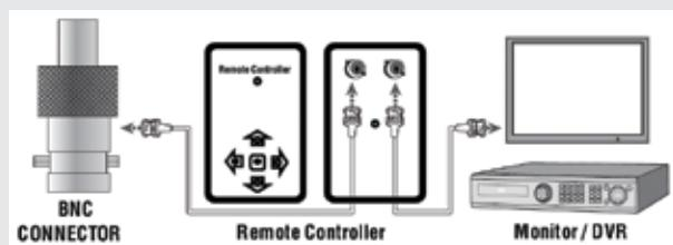
HD-SDI камеры имеют возможность настройки по коаксиальному кабелю (UTC Technology), что минимизирует время и трудозатраты при инсталляции. При помощи пульта управления по coaxialу можно настроить меню камер и сфокусировать объектив. Инсталляторы и пользователи могут настраивать камеру, непосредственно с поста наблюдения.
