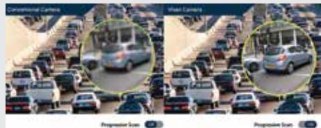
На всех IP камерах MICRODIGITAL используется прогрессивная система сканирования. Эта технология позволяет формировать изображение высочайшего качества, особенно при наблюдении за быстро движущимися объектами. Так как дает возможность избежать эффекта смазывания.
