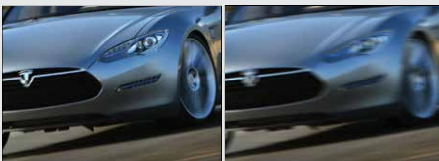
Технология цифровой стабилизации изображения (DIST), реализованная в камерах MICRODIGITAL, устраняет колебания изображения, вызванное вибрацией, так же это позволяет занимать меньший объем HDD при записи.
