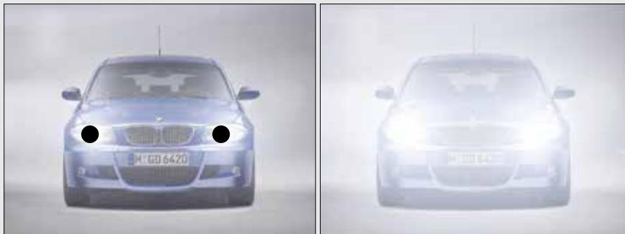
Функция Компенсации Встречных Засветок (High Light Compensation – HLC) которая обеспечивает прекрасную экспозицию для объекта, даже когда очень сильный поток света направлен на объектив камеры, независимо от того перемещается ли наблюдаемый объект, или остается неподвижным.
