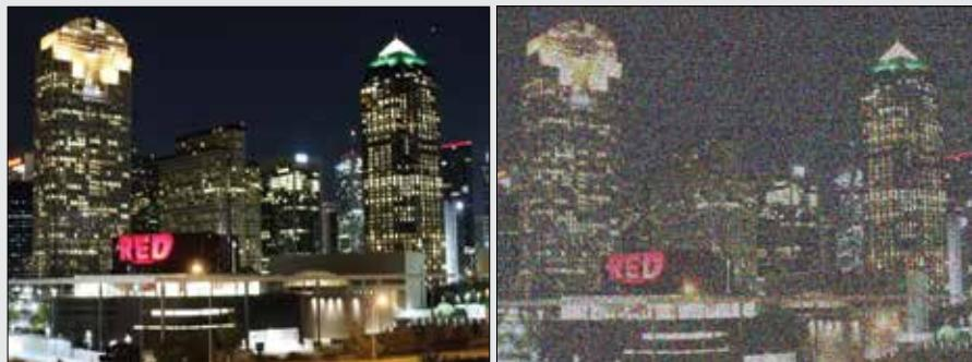
HD-SDI и AHD камеры MICRODIGITAL обладают функцией 3D Снижение Шумов (3DNR). Помехи могут возникнуть, например, при недостаточном уровне освещения. Особенно полезна функция DNR, когда при слабом освещении в кадре появляется движущийся объект. Благодаря функции DNR картинка получается очень четкой и яркой. Также при уменьшении шумов снижается размер файла в архиве.
